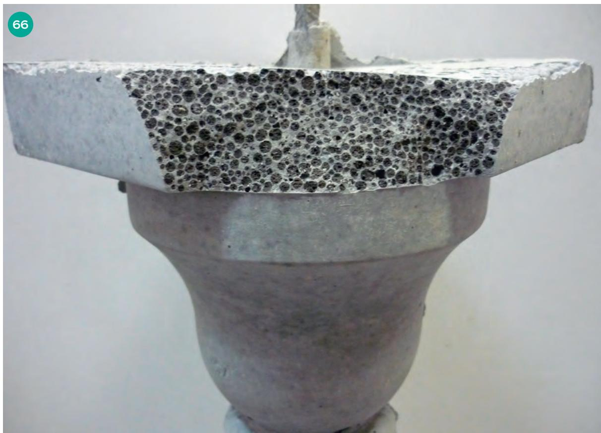
63–64. Архитектурный элемент, выполненный из Рунит Аэродекор. 65–66. Балюсина из Рунит Аэродекор (700×200 мм).
